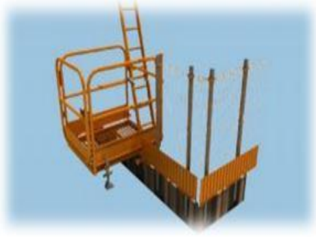
Şekil 11. Geçici kenar koruma yakınında kullanılan merdivene ek önlem
