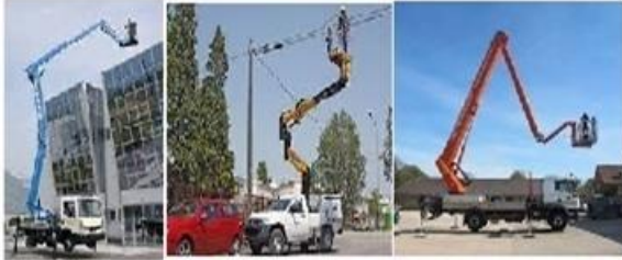
Resim.16 Taşıta monte teleskopik ve eklemli HYÇP
