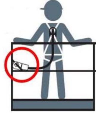
Şekil.21: Çalışma platformu üzerindeki sertifikalı bir bağlantı noktası
